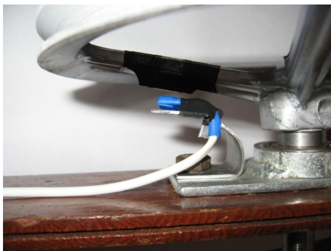
Датчик направления установленный с редукторным переходником.
